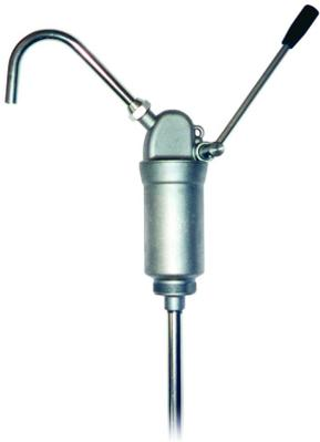
Débit : 375 ml chaque coup. Pour diesel, huile et kérosène 15 lt/min. Avec tuyau d'aspiration rigide et tube de sortie courbé en acier. Grâce au filet Ø 2" on applique la pompe directement sur le fût
