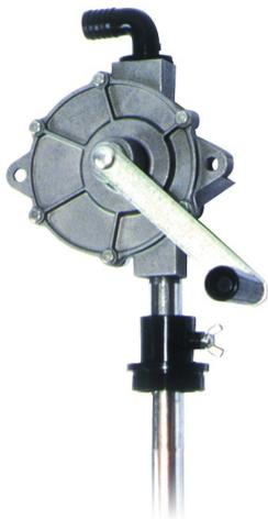
Débit : 300 ml chaque coup. Pour diesel, huile et kérosène 15 lt/min. Avec tuyau d'aspiration rigide et virole. Grâce au filet Ø 2" de la virole on applique la pompe directement sur le fût
