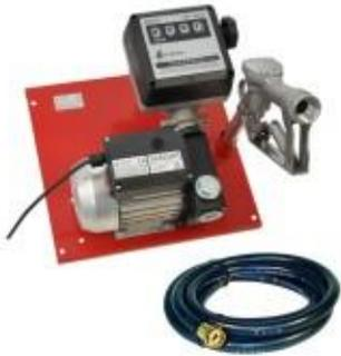
Montée sur une plaque de support en acier à usage privé pour le transfert du diesel. Avec compteur de litres mécanique, tuyau de sortie en caoutchouc (4 mt) et pistolet de distribution en aluminium. Electropompe rotative auto-amorçante volumétrique à palettes.
