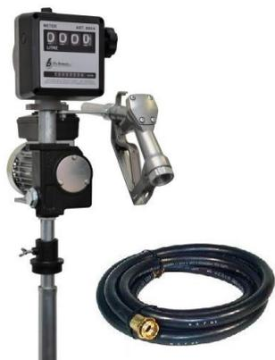
Pour le transfert du diesel. Avec compteur de litres mécanique, tuyau de sortie, tuyau d'aspiration télescopique en acier et pistolet de distribution en aluminium. Electropompe rotative auto-amorçante volumétrique à palettes.
