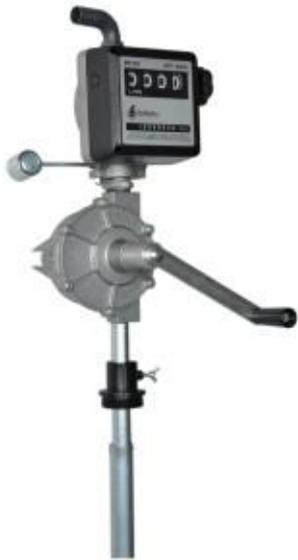
Débit : 300 ml chaque coup. Pour diesel et kérosène 15 lt/min. Avec compteur de litres, support pour pistolet, tuyau d'aspiration télescopique et virole. Grâce au filet Ø 2" de la virole on applique la pompe directement sur le fût
