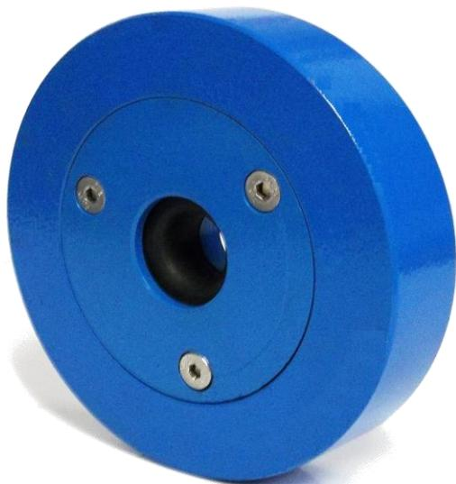
\* Maintien constant du débit grâce à une membrane en caoutchouc insérée dans le corps de l'appareil et dont l'orifice se réduit progressivement sous l'effet de l'augmentation de la pression.
